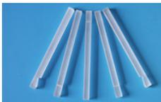
Для выращивания кристаллов, например, сапфира по методу Мусатова, необходимы точно ориентированные стержни, на которых, собственно, и начинается разраствивание материала. Точность ориентации выращенной були определяется точностью ориентации затравки. Наилучшей достижимой для нас точностью является +/-10 угл. мин.
