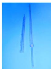
Трубы с изменяющимся по длине поперечным сечением, в том числе, для лабораторных установок по эпитаксиальному росту.
