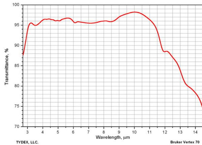
Рис. 2.3. Просветление на 3-5 и 8-12 мкм на германии.
